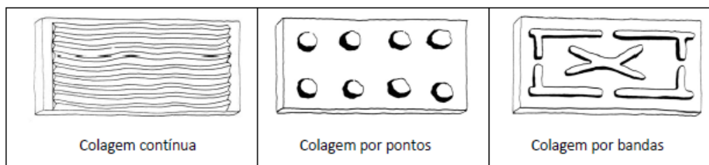
Figura 2.3. Métodos de aplicação do produto de colagem [MENDÃO, 2011]
